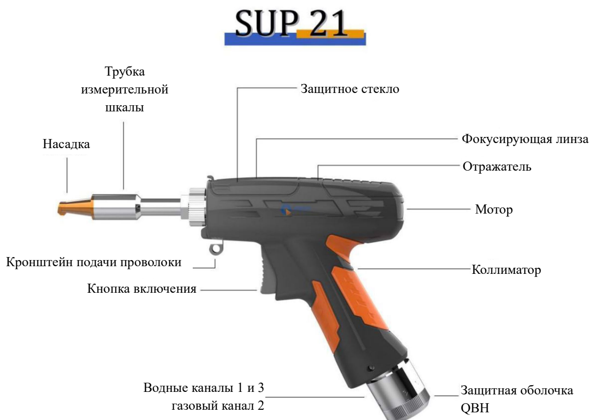
Схема сварочного узла SUP-21Т
